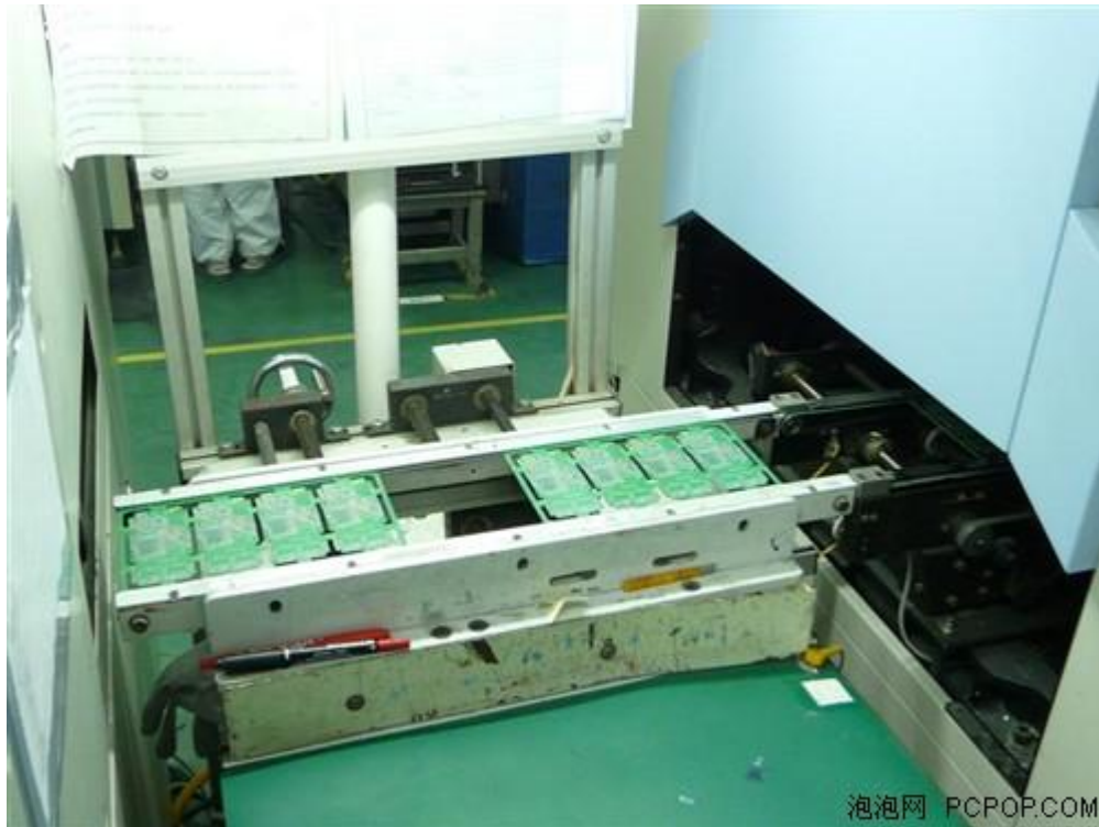
Figure 10. 印刷机把焊锡通过模板印刷在 PCB 板需要焊接的部位 [13] Courtesy http://farm3.static.flickr.com/2642/4166073144_858c9b9df6_o.jpg
