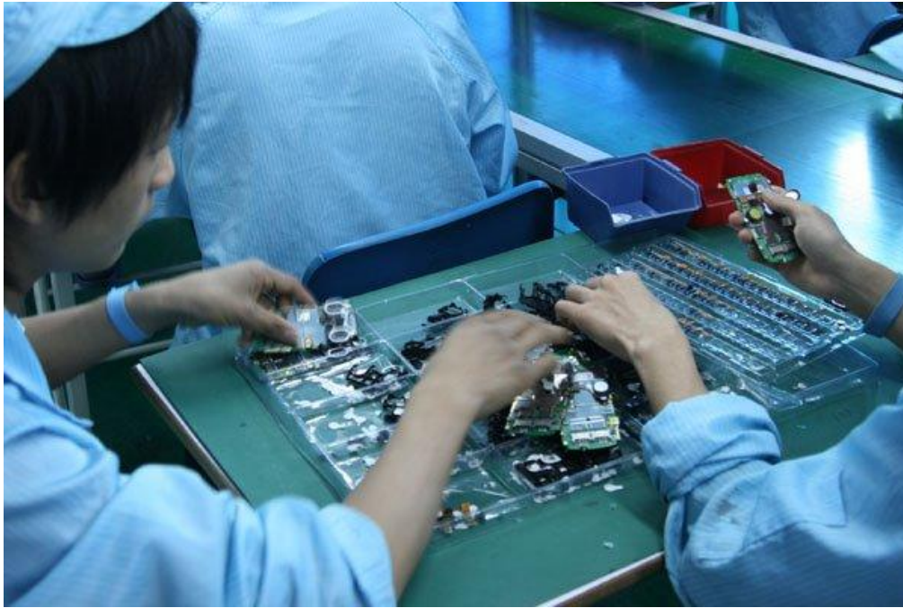
Figure 19. 手工装配无须焊接和螺丝的手机部件 [14]
