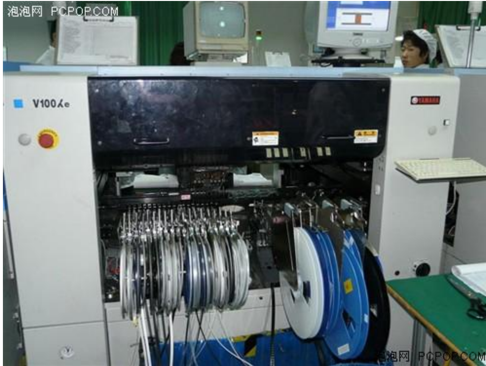
Figure 11. 贴片机把元器件贴装在 PCB 板 [13]
