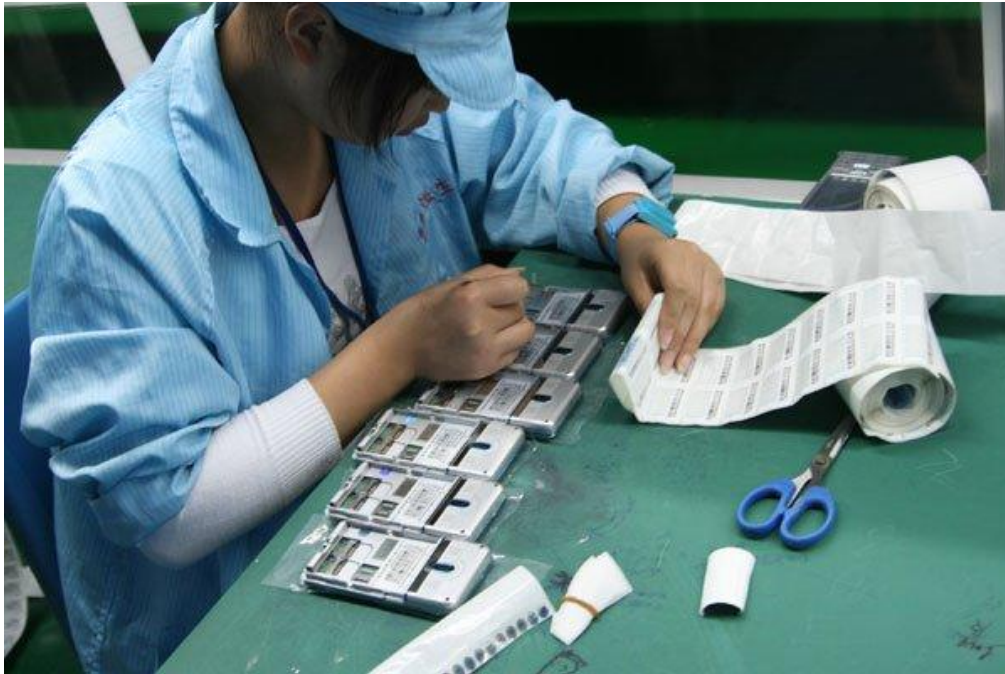
Figure 21. 手工贴手机编码串号 [14]
