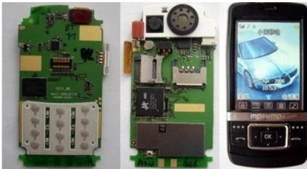
Figure 33. MTK 提供的主板, 组装了外设以后的裸机, 以及装上外壳后的手机 [29]。 Courtesy http://farm5.static.flickr.com/4002/4195300972_a1dd764eb8_o.jpg
