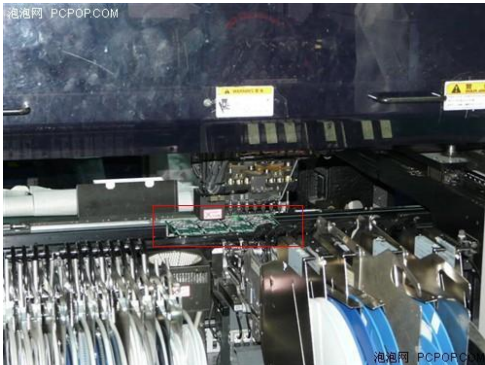
Figure 12. 贴片机近景，小的元器件装在大盘上，大一些的从塑料管中送入贴片机 [13]
