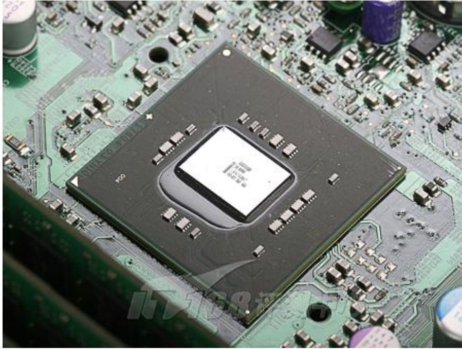
配合 Nehalem-EP 使用的 Intel Tylersburg-EP 芯片
