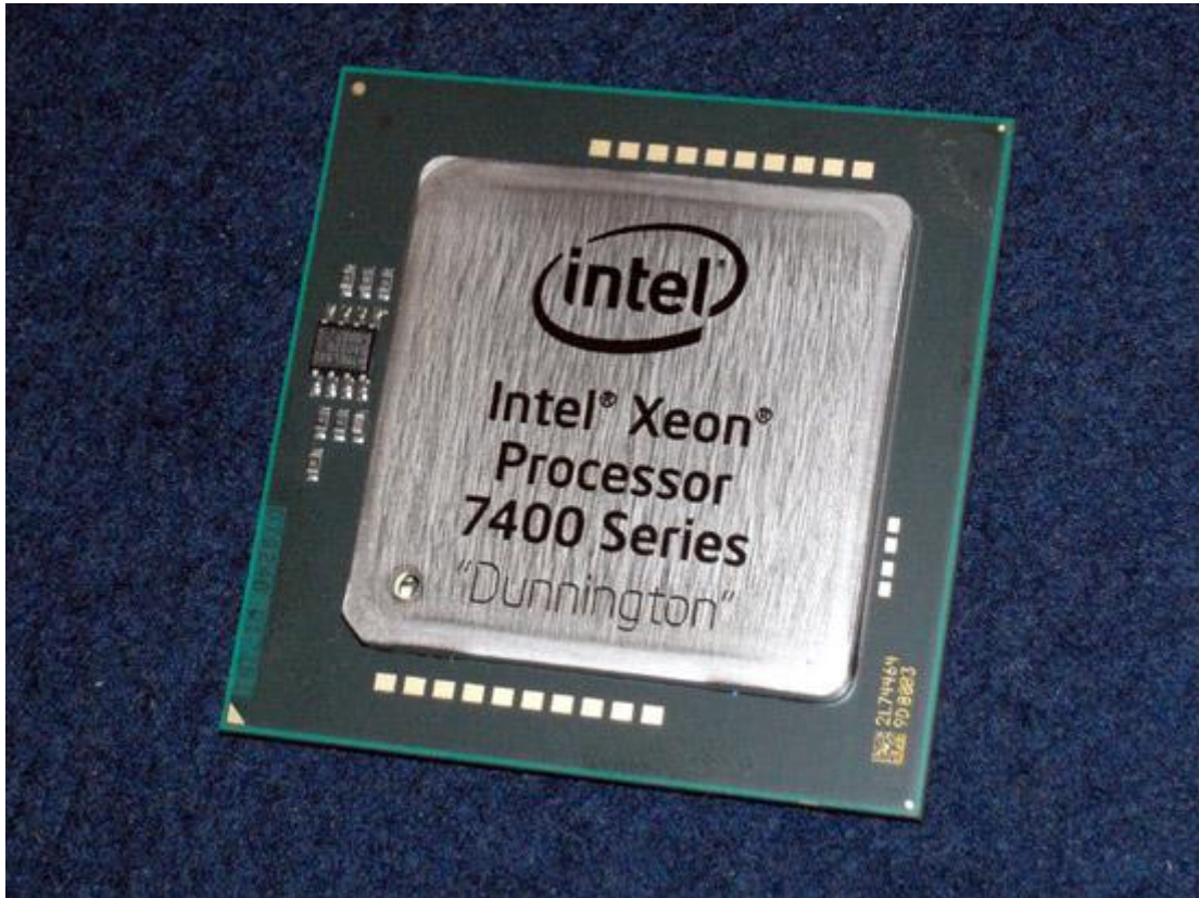
六核心 45nm Penryn 至强 Dunnington 是 Core 架构/FSB 总线的绝唱，并融合了 Nehalem 的“原生单芯”设计
