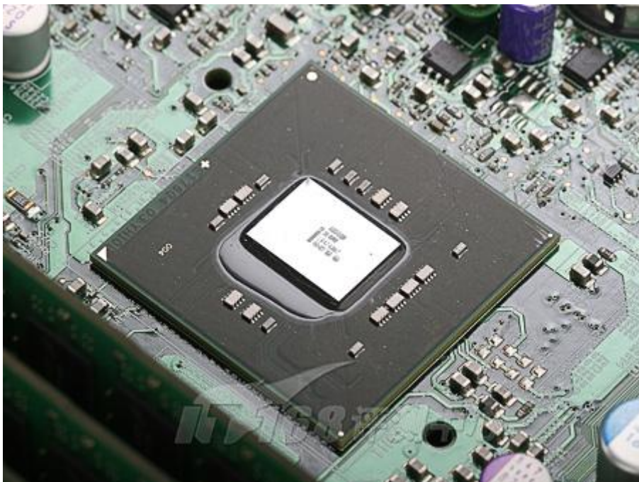
配合 Nehalem-EP 使用的 Intel Tylersburg-EP 芯片
