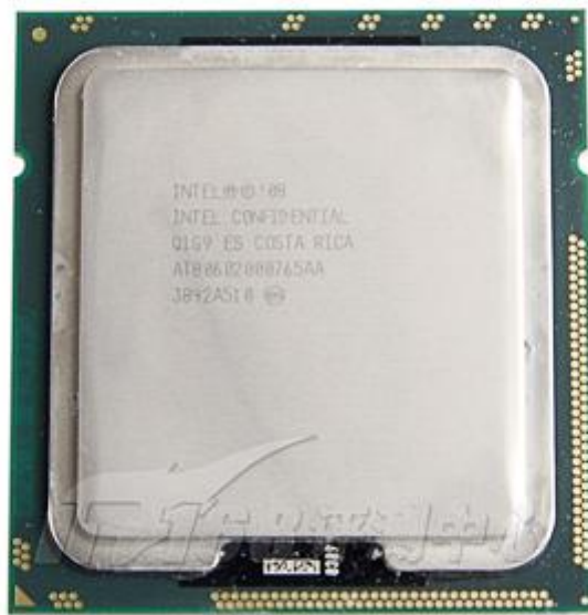
Nehalem-EP: Xeon X5570, 主频 2.93GHz, QPI 频率 3.2GHz
