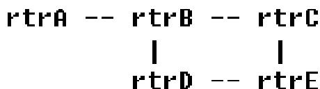
上图中所有的链路都有相同的Cost值10，假设一条TE-tunnel在rtrA 和rtrD之间（采用的是IGP Metric）开始建立。当CSPF计算时把rtrC放到临时列表中（TENTative list），会意识到rtrC不是直接连接的，因此会指定到达rtrC的下一跳（first-hop）信息到rtrC的父亲rtrB上。当rtrA上CSPF算法将rtrD从临时列表中移往路径列表（PATHS list）中时，会意识到rtrD是这条TE-tunnel的末端。因此rtrA会安装一条通过TE-tunnel接口而不是通过rtrB到达rtrD的路由。
