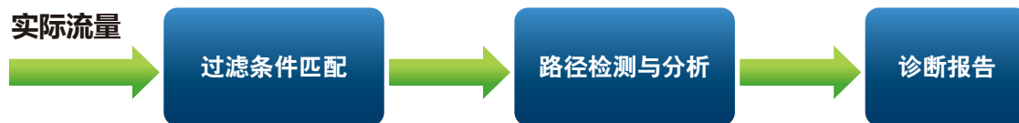
图3 数据包路径在线检测流程图
