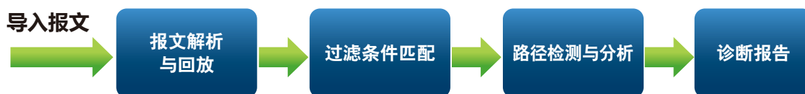
图4 数据包路径导入检测流程图
