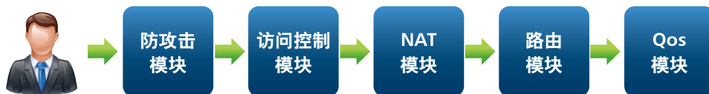
图1 数据包路径检测流程图
